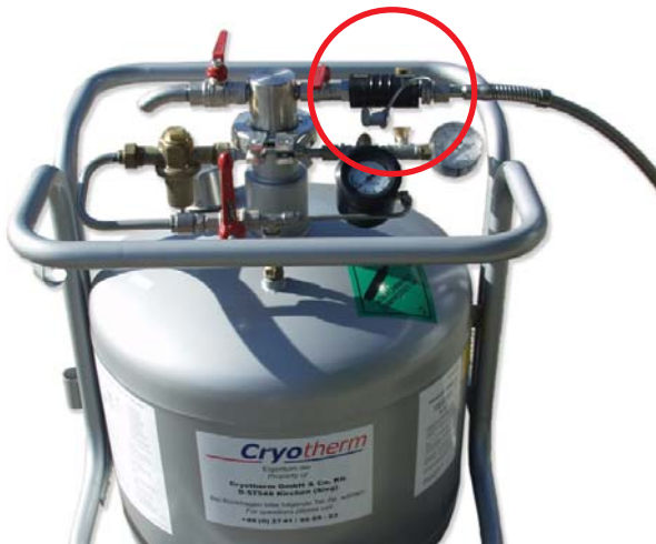
Versorgungsbehälter, hier für flüssigen Stickstoff supply container, here: for liquid nitrogen
