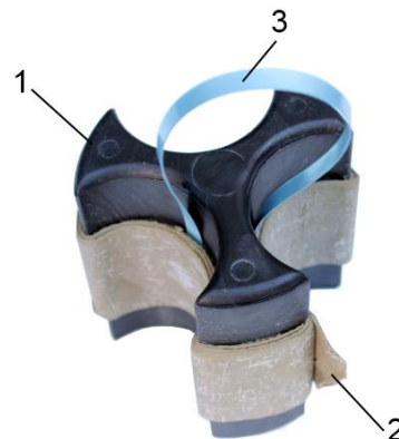
1 Abdicht-/ Distanzstern (Polypropylen) 2 Dichtband Dicke 1 mm Breite 50 mm (ADS-Lieferzustand 3 Lagen) 3 Halteschleife aus Alu-Verbundfolie
